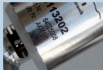
Druckstufenverstellung des Stoßdämpfers, in eingebautem Zustand einstellbar
