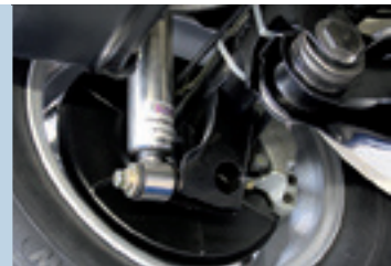
Edelstahl-Stoßdämpfer mit eigenentwickeltem Stabilisator an der Hinterachse eines W111
