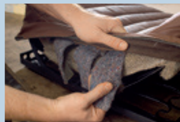
Erneuerung der Gummihaarauflage in erstklassiger Handarbeit
